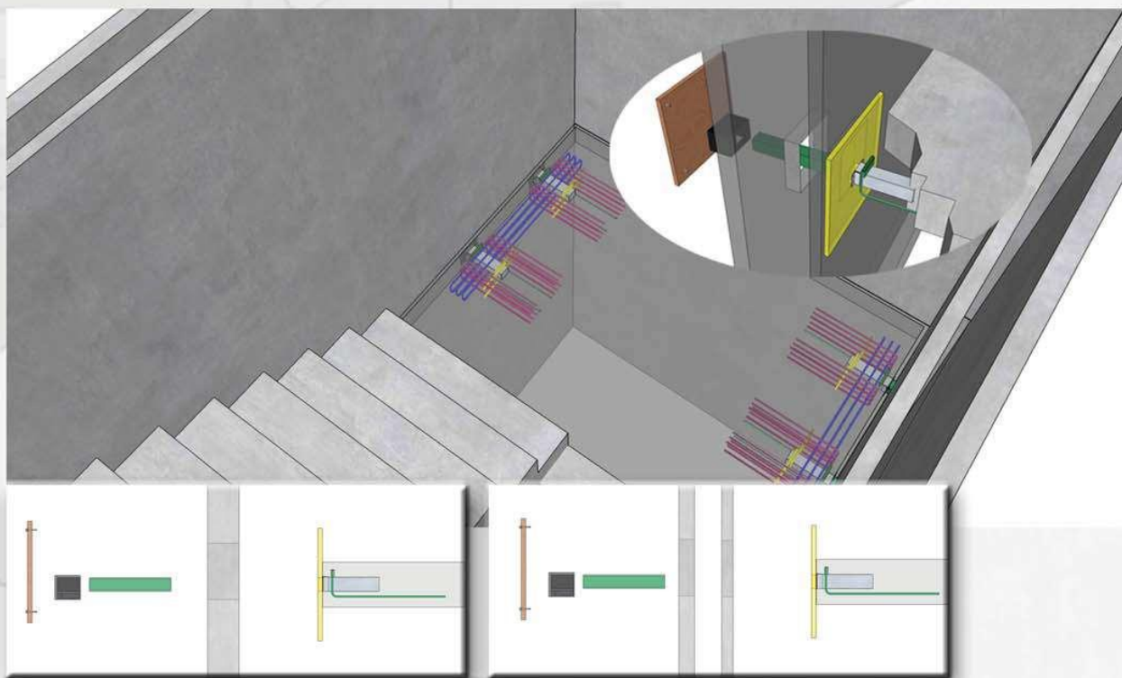
Montage bei Massivbetonwand
